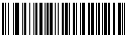
ITF25 comprimento de 22 bits
