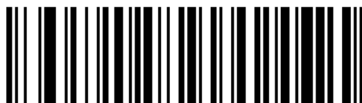
ITF25 comprimento de 10 bits
