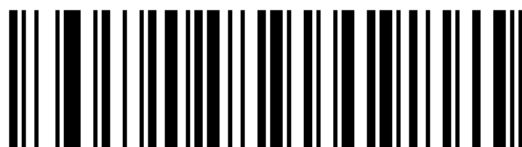
ITF25 comprimento de 20 bits
