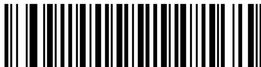
التكافؤ بت حتى واحد، توقف حرف بيانات، بتات 8
