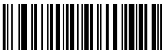
Intercalado 2 de 5 Limite máximo de comprimento
