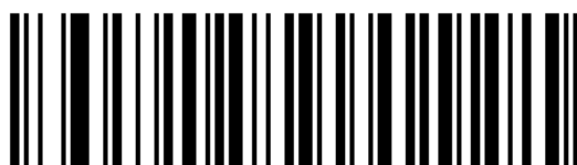
ITF25 comprimento de 16 bits
