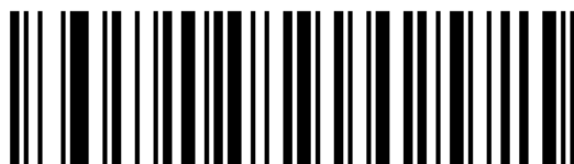
ITF25 comprimento de 12 bits
