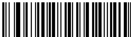
ITF25 comprimento de 14 bits
