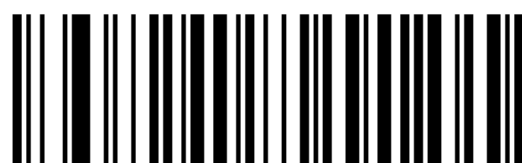
Code 39 La verificación está habilitada pero no se envía ningún dígito de verificación
