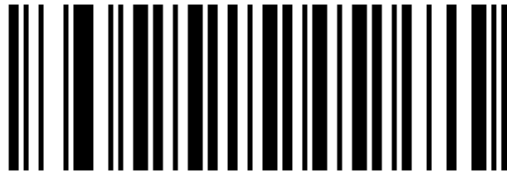
UPC-E não envia dígitos de verificação
